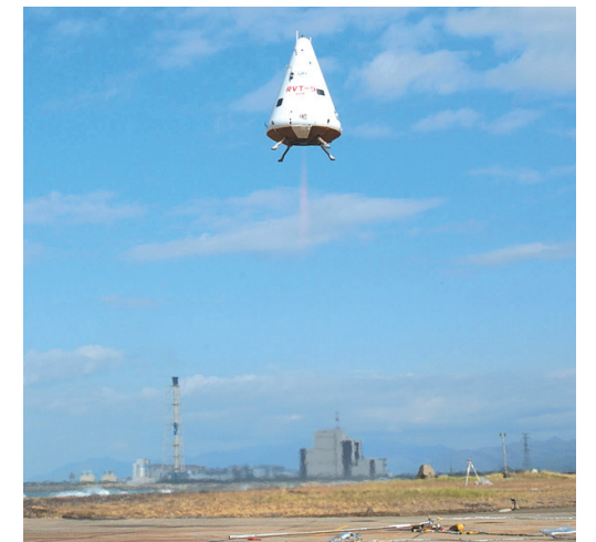
再使用ロケット実験機の垂直離着陸実験(2003年10月)
