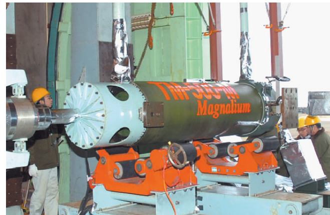
マグナリウム入り固体コンポジット推進薬を用いる固体モータの技術実証試験(2006年12月)
