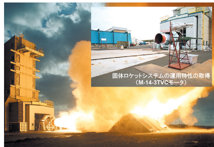
大型固体ロケットモータの地上燃焼試験におけるシステム運用特性の取得(M-14-3TVCモータ)
