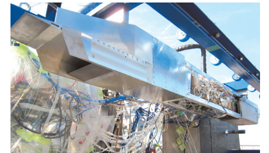
小型予冷ターボジェットエンジンの燃焼試験(2007年11月)
