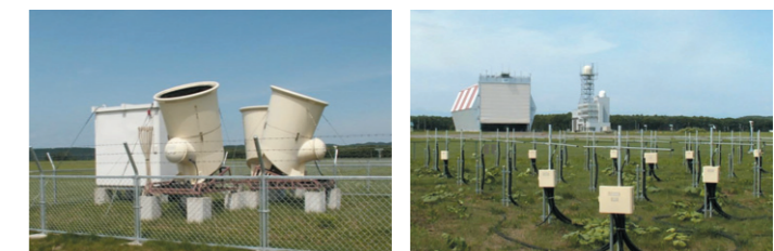
気象の予測に用いるドップラー風速計(左)とVHFレーダ(右)
