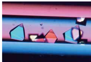
「きぼう」で生成された高品質なタンパク質の結晶 High-quality protein crystals grown on "Kibo"
