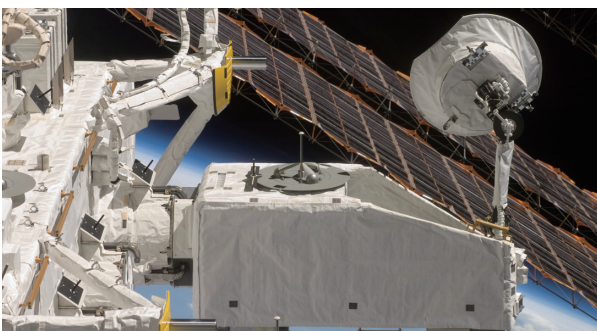
▲「きぼう」日本実験棟船外実験プラットフォームに取り付けられた衛星間通信システム曝露系サブシステム Inter-orbit Communication System-Exposed Facility subsystem: ICS-EF
